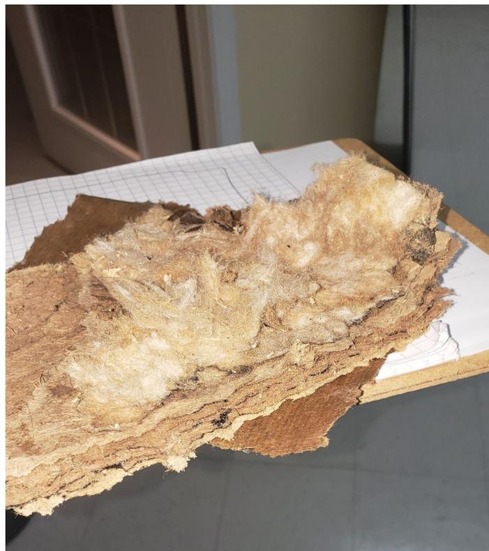
Photo 24 – Sondage #2B, échantillonnage de la composition du plafond
